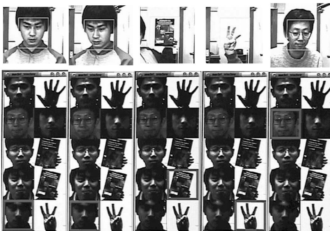
図 18 ダイナミックリングアーキテクチャに基づく画像認識。上段：入力画像（白線の枠内が認識領域），下段：10 個の記憶画像からの認識結果（太線枠）
